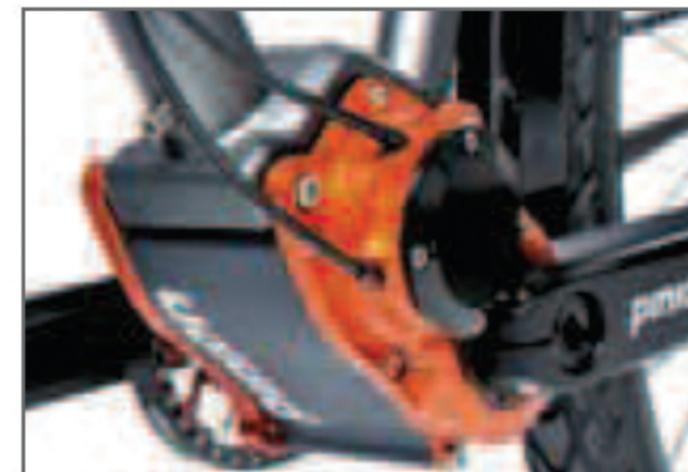
Das Pinion-Getriebe hat einen gigantischen Übersetzungsumfang.
